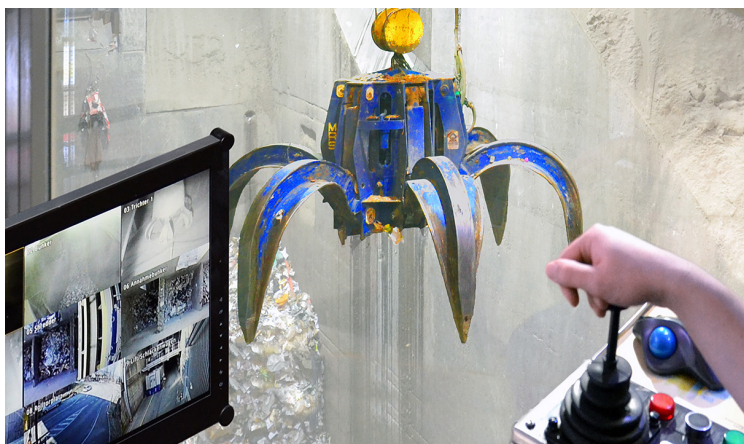
Le grutier voit notamment sur son moniteur la fosse, le broyeur, la trémie, etc..
